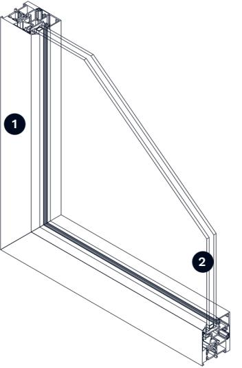
① Perfil aluminio con rotura de puente térmico
